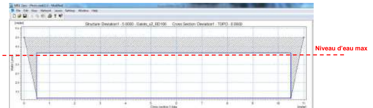
Figure 40 : Evolution du niveau maximale pour une pluie centennale sur les profils en travers au droit des ouvrages de franchissement de la RD106
