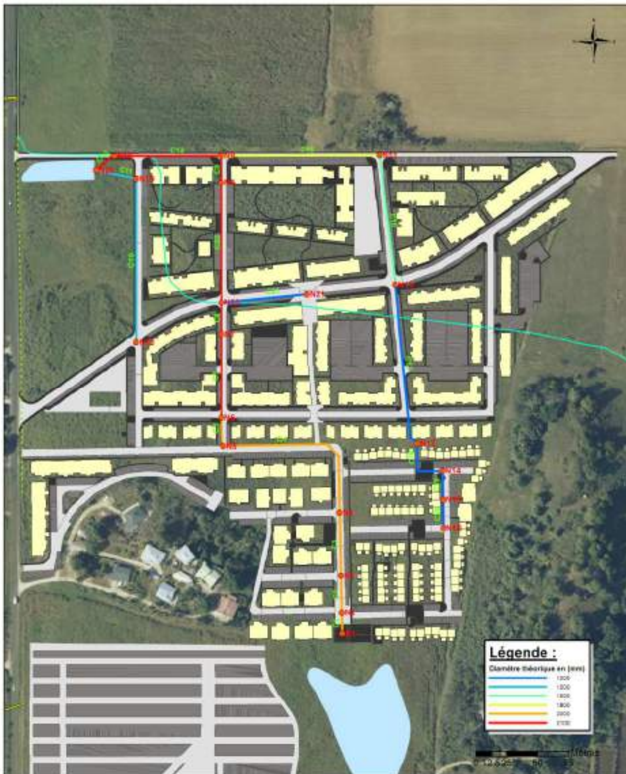
Figure 37 : Dimensionnement du réseau structurant pour (T = 10 ans)
